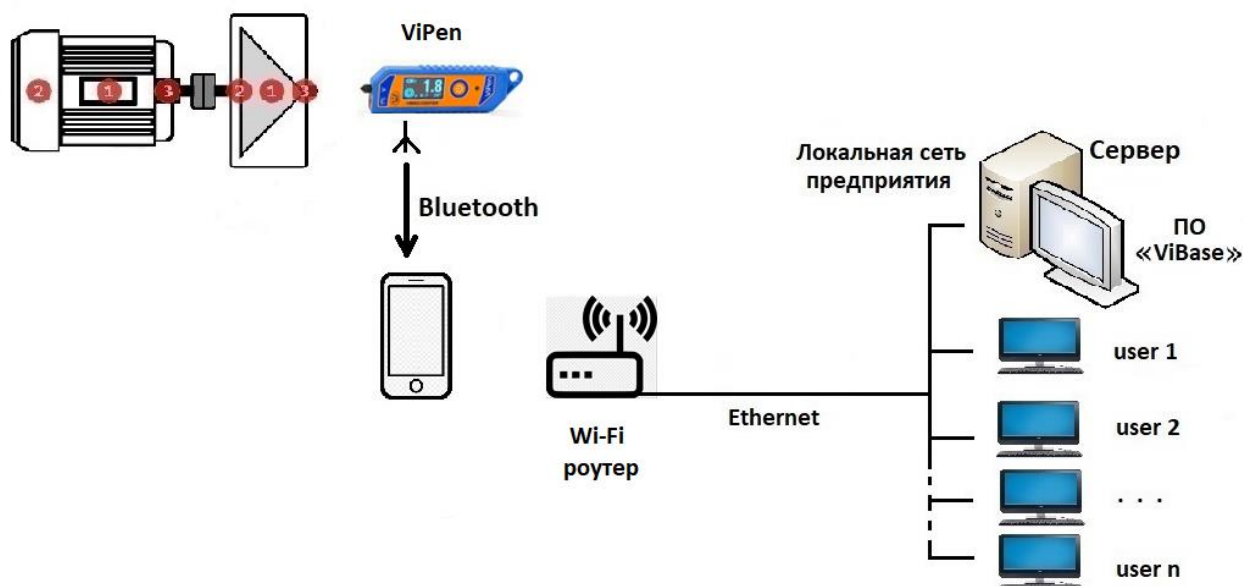
Рис. 2.1. Условная схема реализации системы контроля вибрации с использованием ViPen.
