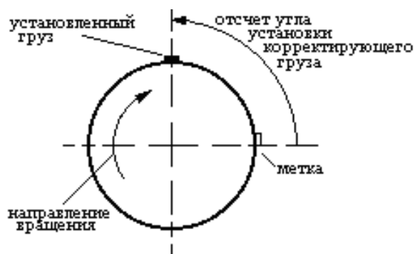
Направление отсчета положительного угла установки корректирующего груза
