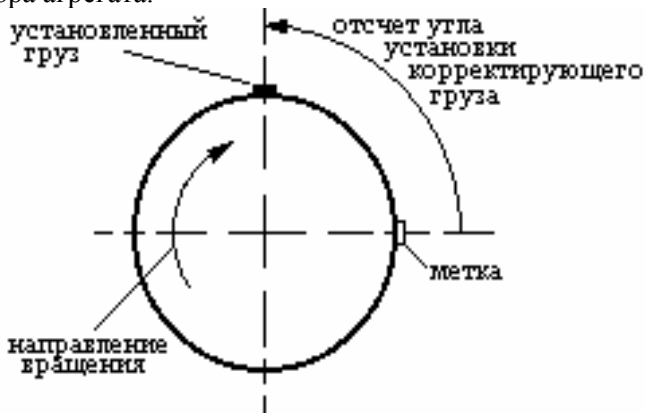
Рисунок 22 - Направление отсчета положительного угла установки корректирующего груза.
