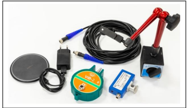
Такая конфигурация технических средств прибора марки ViB-2 является универсальной и используется для проведения одно- и двухплоскостной балансировки роторов в собственных опорах.
