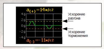
удобства работы пользователь может выбрать в приборе два предела измерения ускорения кабины: ± 1g или ÷4g. Поскольку для повышения точности измерений в приборе «ДПК-Вибро-Лифт» увеличенной использован датчик С значения чувствительностью, максимальные ускорения измеряемых в режиме виброметра уменьшилось до 50 м/с2, а виброскорости - до 80 мм/с. Максимальное значение измеряемого виброметром «ДПК-Вибро-Лифт» перемещения осталось прежним - до 500 мкм.
